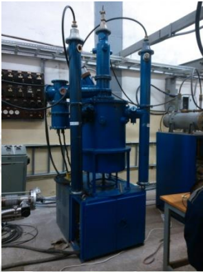
Оконечный каскад на GI-27AM
