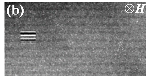
ТЕМ изображение монокристалла \text{Cr}_{1/3}\text{NbS}_2 , T=110 \text{ K} , H = 2 \text{ kOe}
