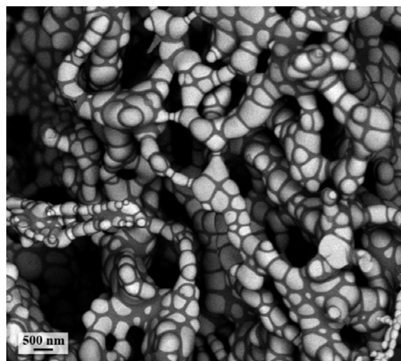
Рис. 1. Морфология оксида ZrO_2-HfO_2-Y_2O_3 , синтезированного при 1200^\circ C
